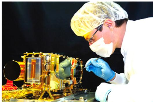
Photo 11. Pose des thermocapteurs sur l'instrument Chemcam
